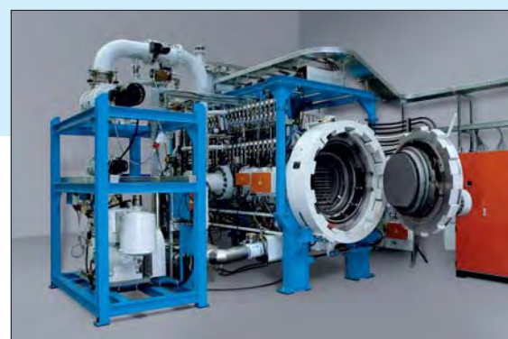
Vakuum-Drucksinteranlage zum Sintern von Hartmetalleilen Quelle: PVA TePla AG
