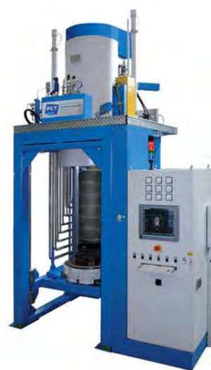
Gasdrucksinterofen 2.220 °C, 100 bar, zur Herstellung von Wendeschneidplatten Quelle: FCT Systeme GmbH Rauenstein
